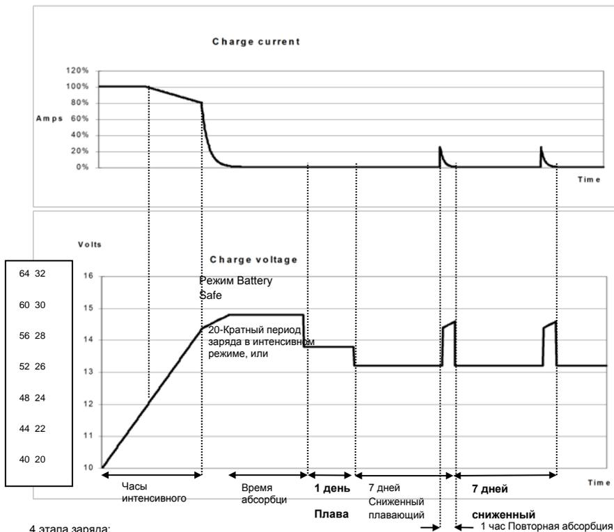
**Интенсивный режим:** Активируется при подключении батареи. Подается постоянный ток до достижения напряжения газообразования (14,4 В или 28,8 В с температурной компенсацией).
