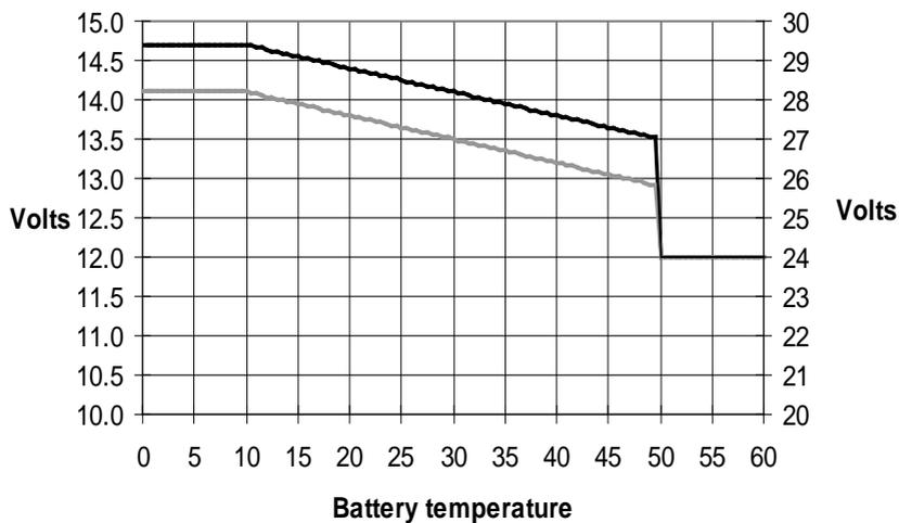
Значения выходных напряжений по умолчанию для Абсорбционного и Плавающего режимов приведены для температуры 25°C.
