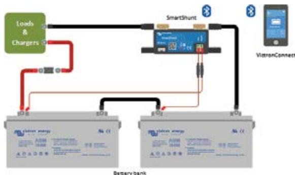
Messen des Mittelpunkts der Batteriebank
